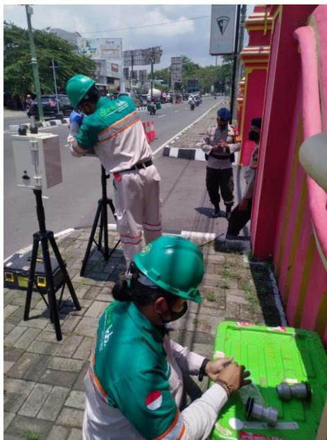
**Gambar III.3 Pemantauan udara ambien dengan *passive sampler***
